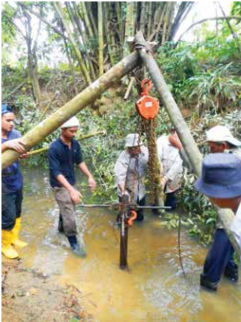
Persampelan konsentrat mineral berat menggunakan pam selut Sampling of heavy mineral concentrates using sludge pump
