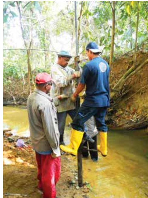
Persampelan konsentrat mineral berat menggunakan pam selut Sampling of heavy mineral concentrates using sludge pump
