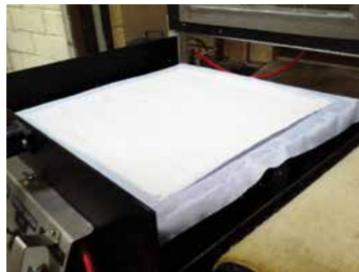
Pemendakan in situ PCC ke dalam lumen pulpa untuk pembuatan kertas di atas permukaan kain In situ deposition of PCC in the lumen pulp for paper making on the surface of the cloth
