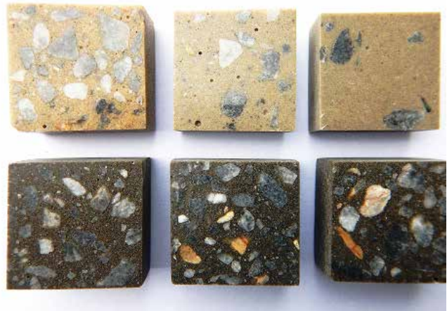
Komposit marmar yang dihasilkan dari sisa dolomit dan andalusit tempatan Marble composite produced from local dolomite waste and andalusite
