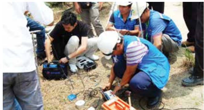
Kerja pengukuran gegaran bumi dan ledakan udara dengan menggunakan alat vibrometer di sekitar kuari Ground vibration and air blast measurements using vibrometer equipment at the vicinity of quarry sites
