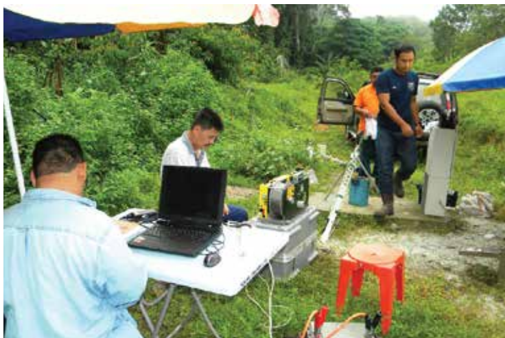
Pengelogan geofizik untuk perakuan air mineral di kawasan Sik, Kedah Geophysical logging for mineral water certification in Sik area, Kedah
