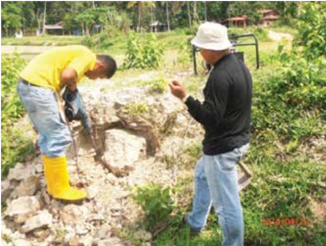
Persampelan debu vulkano menggunakan gerudi tangan di Kampung Pok Ka Sampling of volcanic ash using hand drill in Kampung Pok Ka
