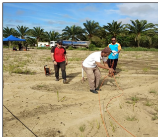
Survei geofizik kaedah transient electromagnetic (TEM) untuk kajian sumber air panas di Muar, Johor.
