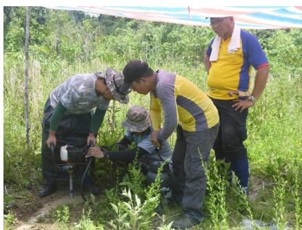
Persampelan arang batu menggunakan gerudi tangan di Blok Betalong, Sarawak
