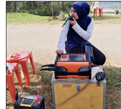
Survei keberintangan elektrik 2D yang dijalankan di Jempol, Negeri Sembilan
