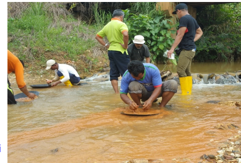
Kerja mendulang bagi mendapatkan sampel konsentrat projek kajian emas di Kuala Krai, Kelantan
