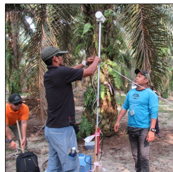
Cerapan data magnetik menggunakan peralatan Magnetometer di Pulau Manis, Kuantan, Pahang
