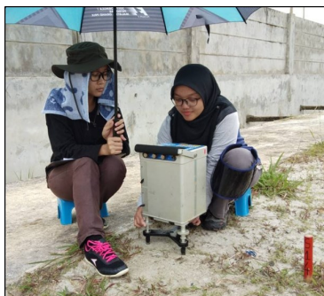
Cerapan data graviti menggunakan peralatan Gravimeter Scintrex CG5 di Miri, Sarawak
