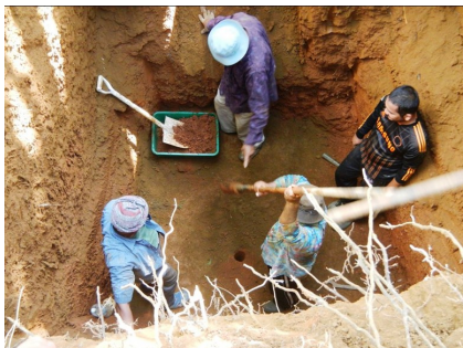
Kerja-kerja penggerudian auger tangan untuk menentukan ketebalan lapisan tanah yang mengandungi bauksit
