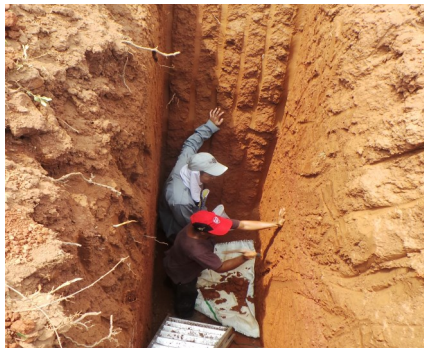
Membuat log dan persampelan bauksit dalam lubang korekan di Felcra Bt. Segumpal
