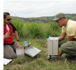
Cerapan data graviti dengan alatan Scintrex CG5 dan data ketinggian dengan alatan barometer semasa survei graviti di Kota Belud Sabah
