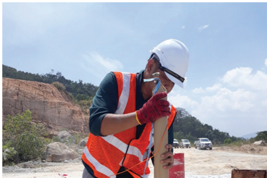
Gambarajah 6. Calon sedang diuji kaedah cajung bahan letupan dengan menggunakan “blasthole liner”.
