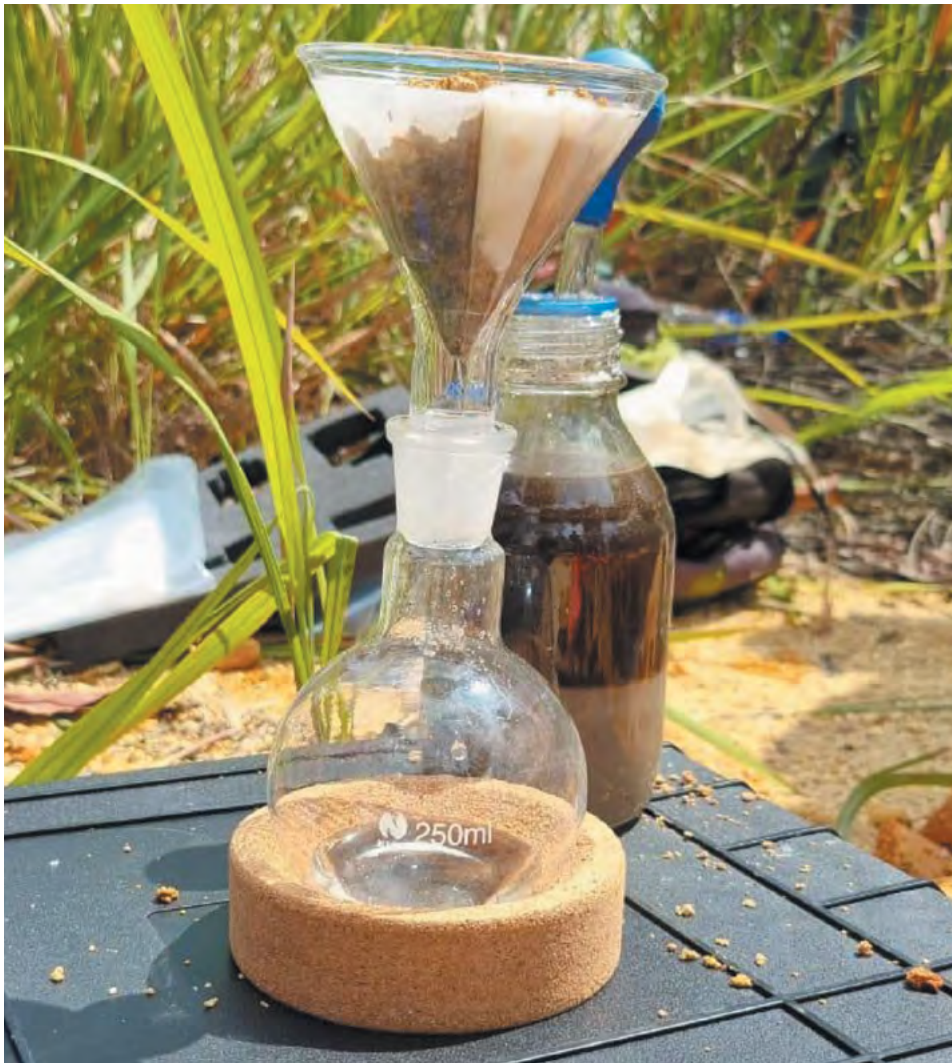
Foto 7: Ujian pemendakan dilakukan di lapangan dengan menitiskan larutan ammonium sulfat ke atas sampel lempung.
