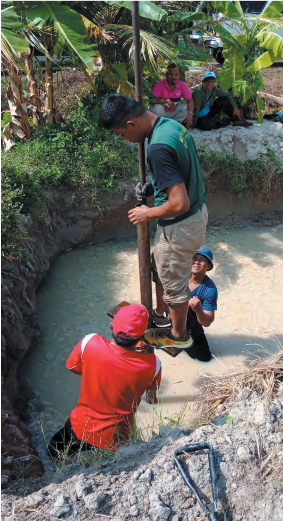
Foto 6: Persampelan konsentrat daripada deposit plaser menggunakan sludge pump .
