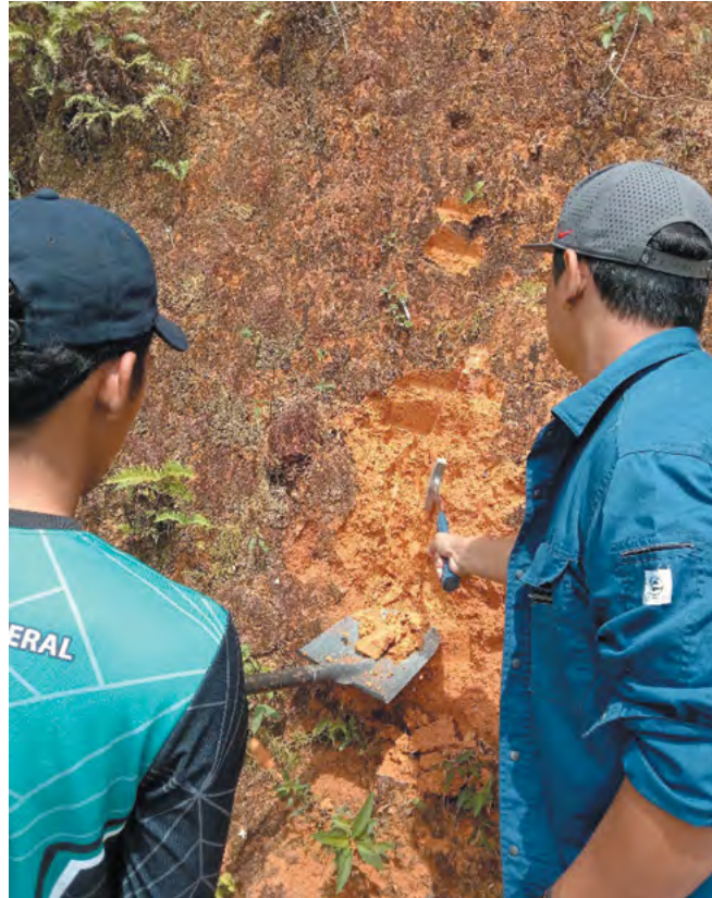
Foto 4: Pensampelan pada potongan cerun pada horizon B secara alur.
