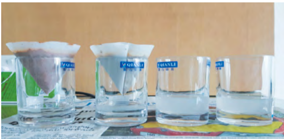
Foto 8: Pemendakan REE oksalat di dalam larutan asid oksalik.
