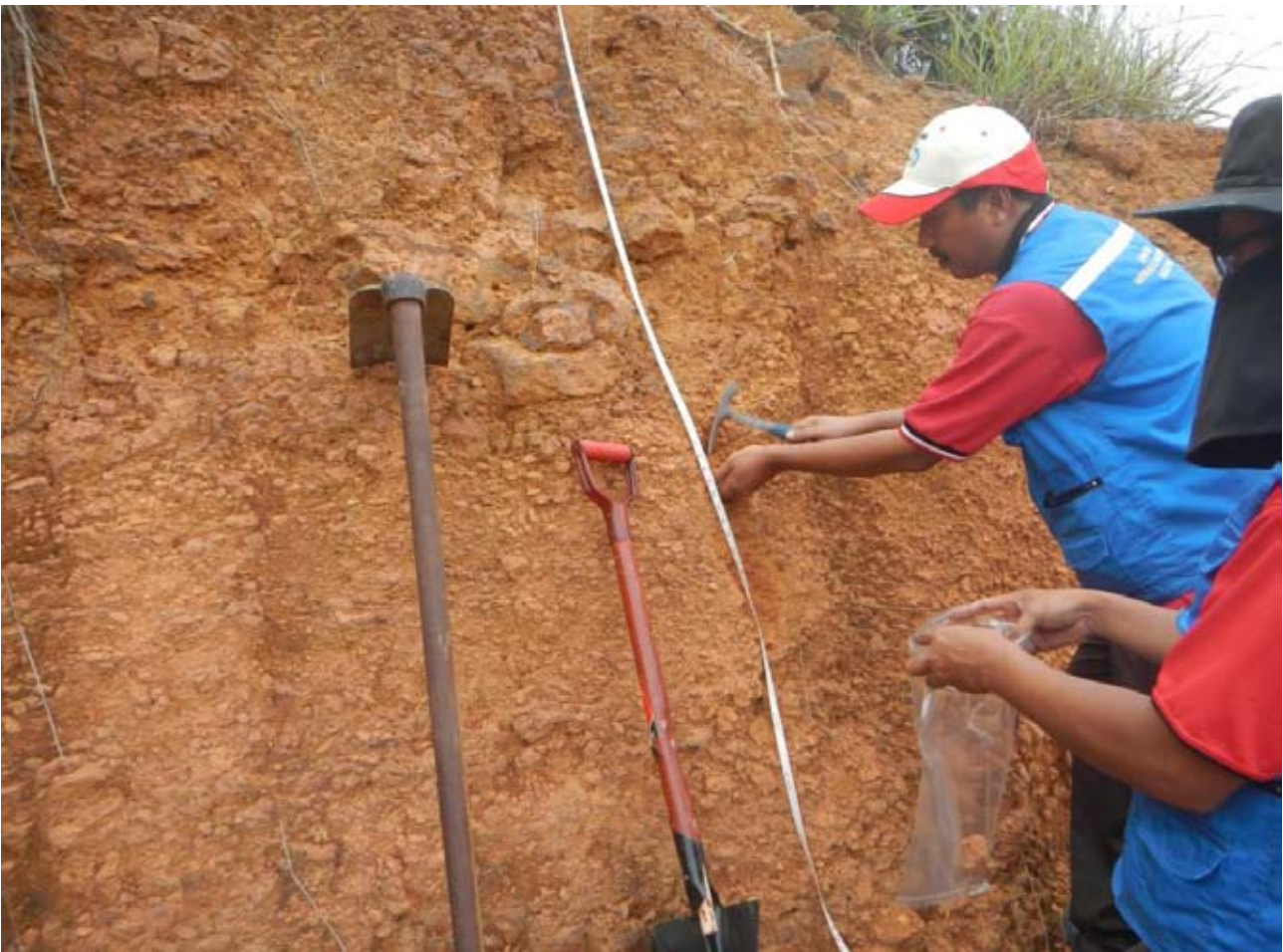
Foto 4 : Aktiviti pengambilan sampel bauksit dalam zon luluhawa berlaterit yang mengandungi nodul bauksit pada singkapan di kawasan Bukit Bangsalop, Pengerang, Johor
