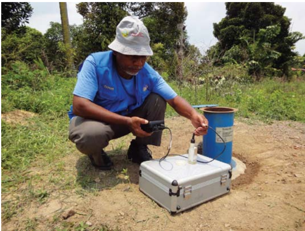
Foto 3 : Kaedah on-site bagi pengukuran parameter pH, suhu dan konduktiviti.
