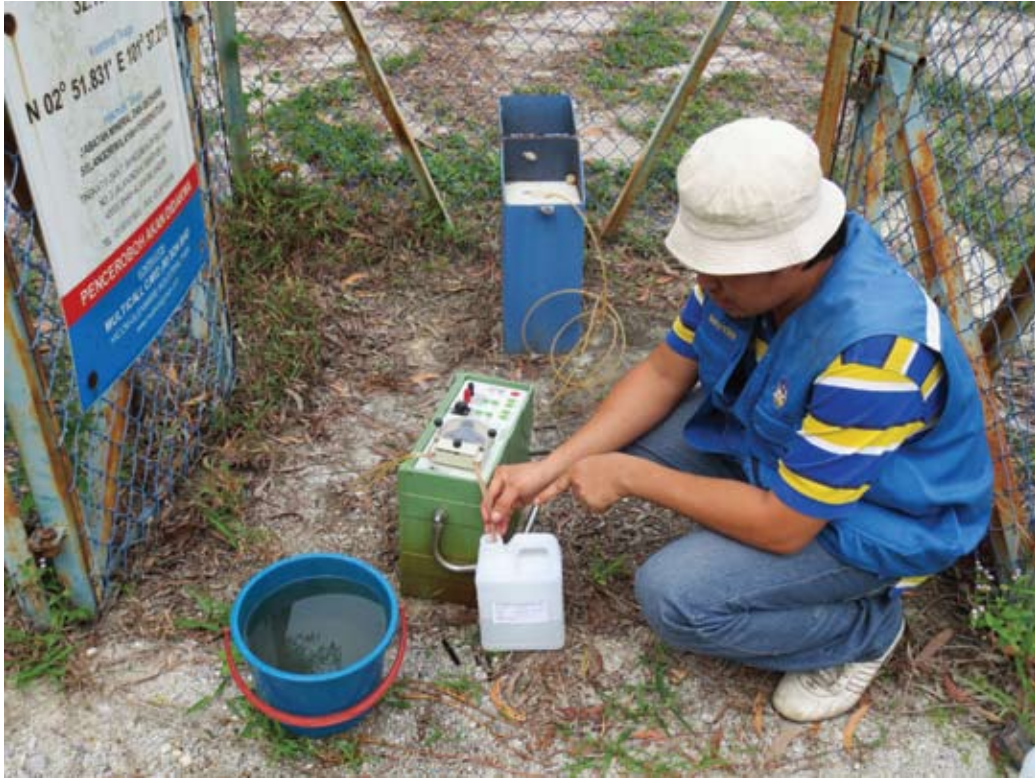
Foto 4 : Pengambilan sampel air tanah menggunakan pam peristalsis.
