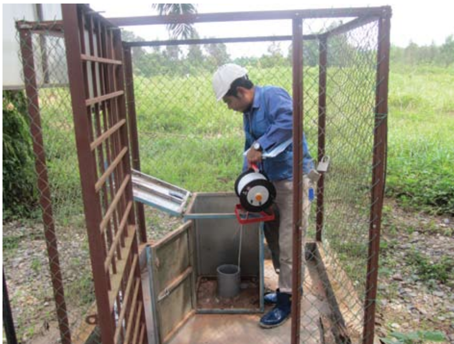
Foto 1 : Pengukuran Paras Air Tanah Di Lapangan
