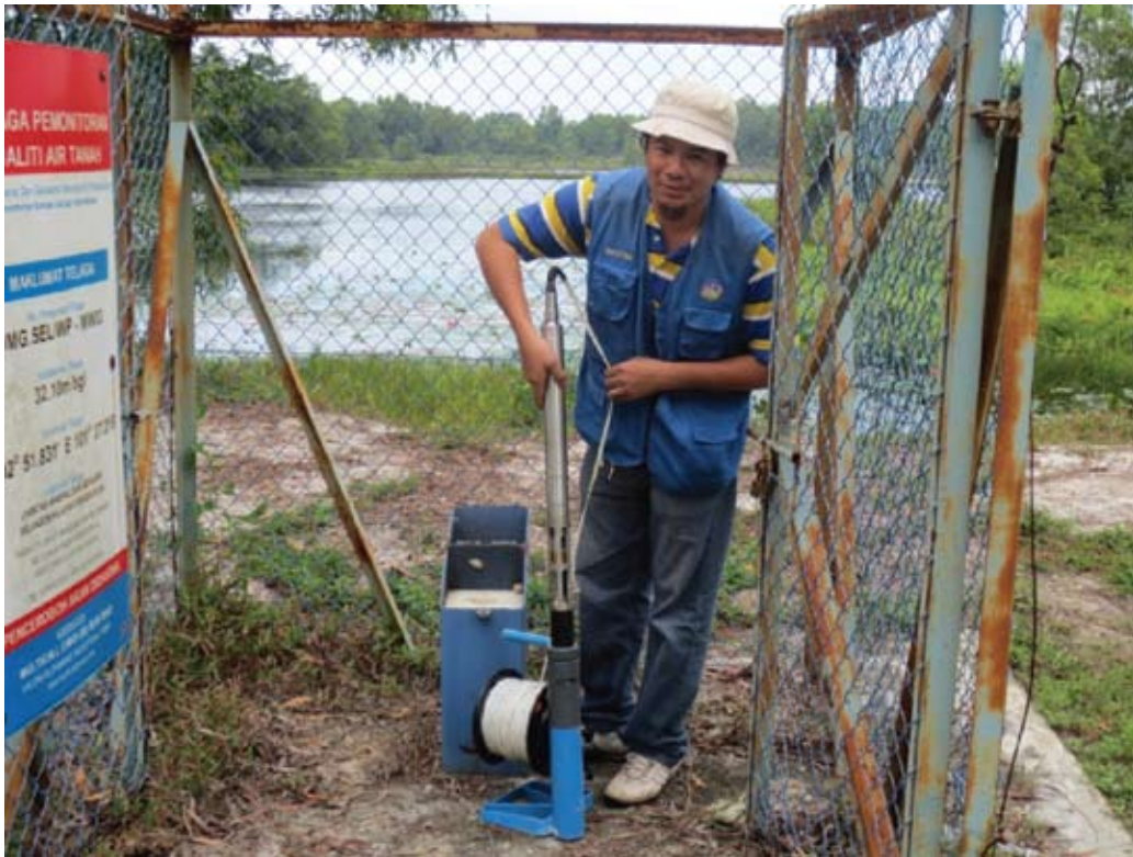
Foto 2 : Kaedah in situ bagi pengukuran parameter pH, suhu dan konduktiviti.
