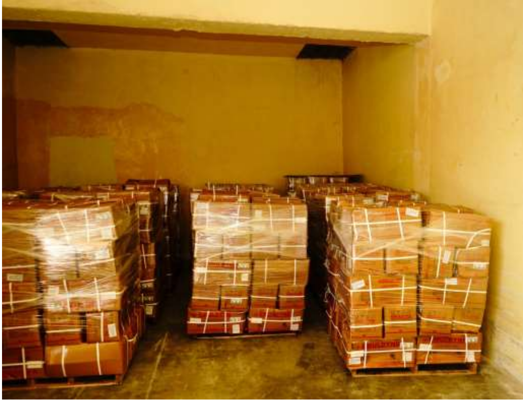
Gambar 5: Kotak bahan letupan disusun di atas pelet kayu. Terdapat lubang udara di bahagian siling magazin untuk sistem ventilasi
