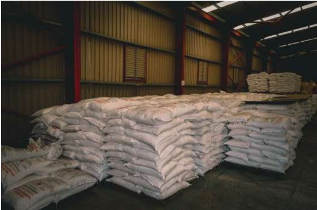
Gambar 7: Beberapa guni Ammonium Nitrat (25 kg) disusun dan diletakkan atas pelet kayu di dalam magazín penyimpanan Ammonium Nitrat
