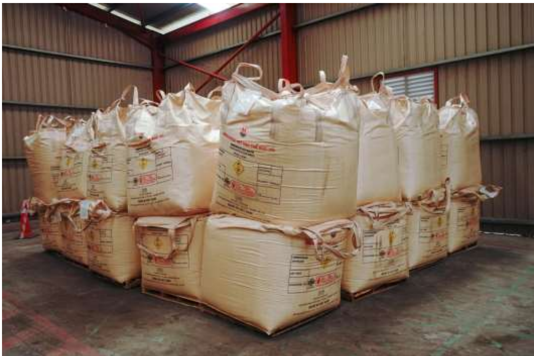
Gambar 8: Beberapa beg jumbo Ammonium Nitrat (1 metrik tan) disusun dan diletakkan atas pelet kayu di dalam magazín penyimpanan Ammonium Nitrat
